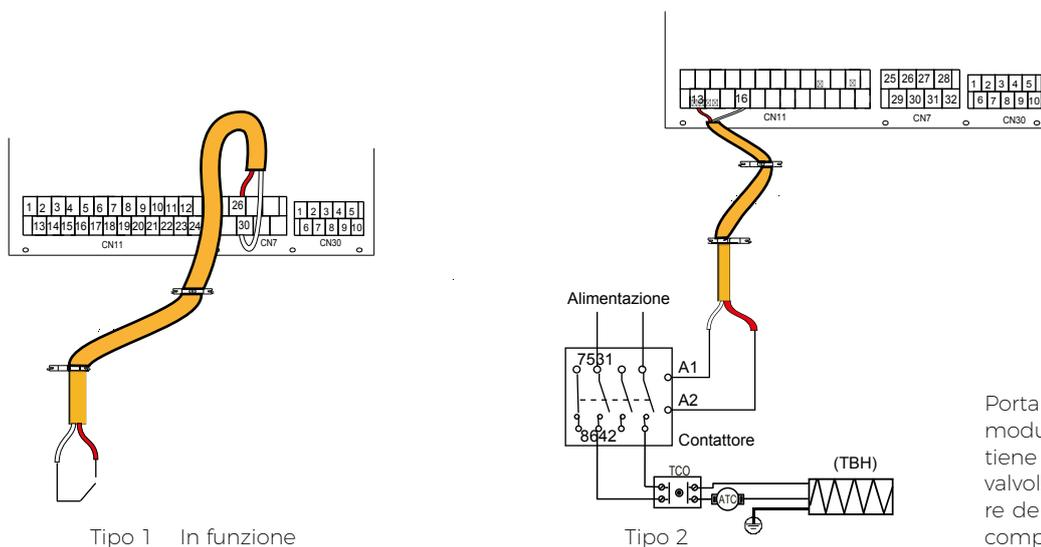
Porta del segnale di controllo per il modulo idraulico: il CN11/CN7 contiene i terminali per l'energia solare, la valvola a 3 vite, la pompa, il riscaldatore del bollitore, ecc. Il cablaggio delle componenti viene illustrato di seguito:
