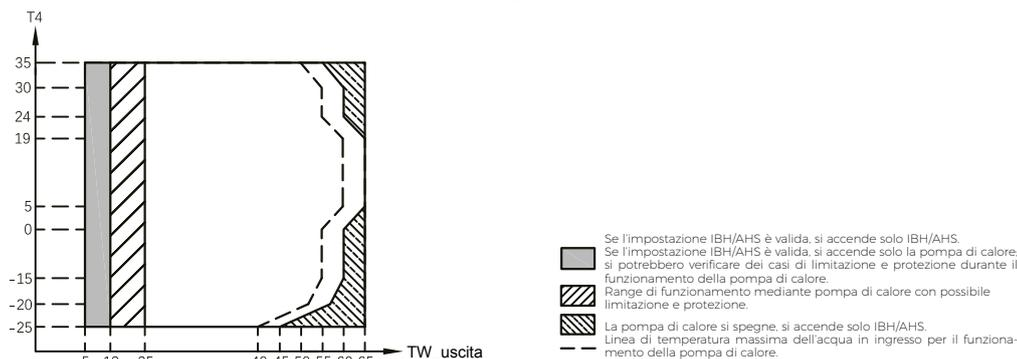
Nella modalità ACS, il range della temperatura di scorrimento dell'acqua (TW\_out) con diverse temperature ambiente (T4) viene elencato qui di seguito:
